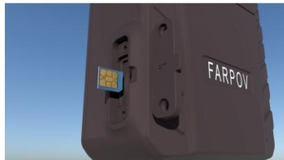
2, 打开手机浏览器（支持电脑、平板），输入[www.farpov.net](http://www.farpov.net)进入系统登陆界面；输入相机背面铭牌中的用户名和密码，进入控制系统；将系统拍摄间隔设置为1分钟（预览工作必须在间隔1分钟模式下执行）。
