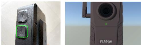
4, 按一下相机“预览按钮”，镜头下LED红灯闪亮，说明相机已经进入系统；按住“预览按钮”3秒，镜头下LED常亮，相机打开预览功能。
